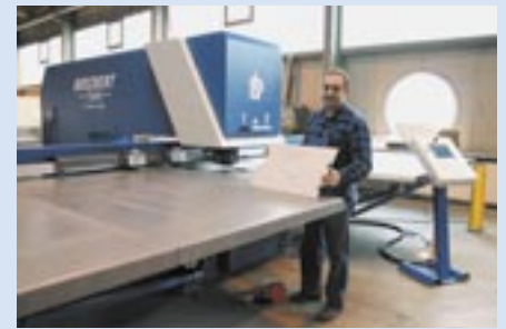
Die CNC-Stanzmaschine der Twin Baureihe von Boschert ist mit zwei unabhängigen Stanzköpfen ausgerüstet. Stanzkopf 1 fertigt mit 360° stufenloser Rotation zum Beispiel alle Konturen. Stanzkopf 2 ist ausgerüstet mit dem 8-fach-Revotool, mit dem acht verschiedene Löcher gestanzt werden können. Die Maschine gilt in Fachkreisen als Arbeitsbiene für die Dünnschleibearbeitung. „Ein echter Alleskönner für Konturen und Lochbleche“, sagt Janus Schemoschek (Foto), Stellvertreter von Hans-Hinrich Bruns, nach ersten Probeläufen.
