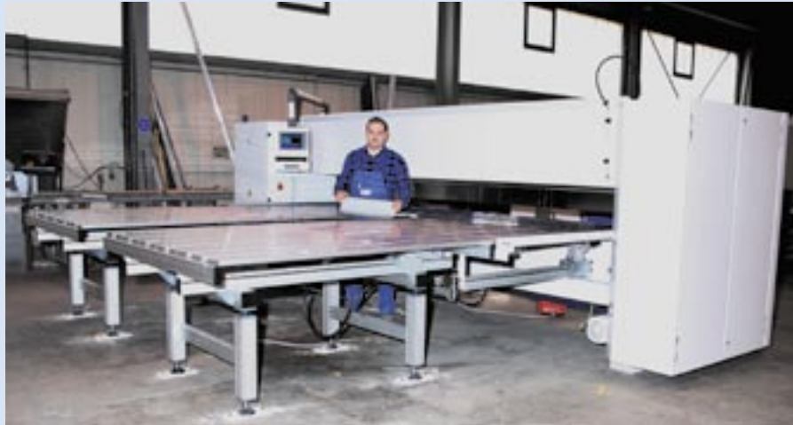
Zu den Newcomern in der Halle gehört eine Schwenkbiegemaschine Schröder Multi Power Bend. Sie ist extrem schnell und durch die Touchscreen-Grafiksteuerung äußerst präzise.
